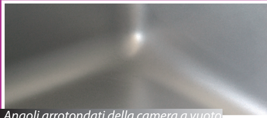
Angoli arrotondati della camera a vuoto
