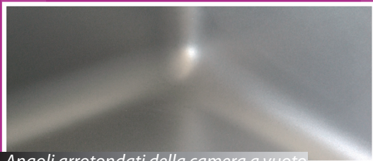
Angoli arrotondati della camera a vuoto
