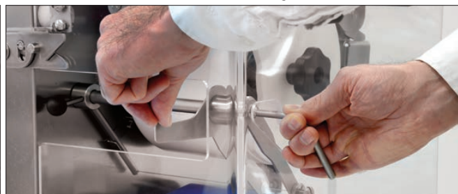
Pulizia filo a macchina accesa - Wire cleaning with machine on
